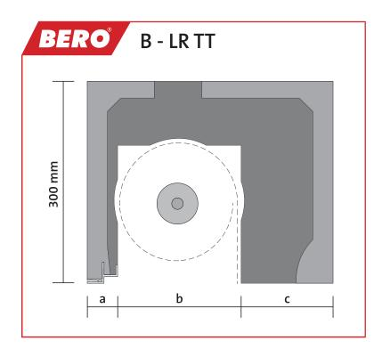
Selbsttragender Rollladenkasten aus bewehrtem BEROpor-Leichtbeton mit einer äußeren Montageöffnung für einen linksrollenden Rollladen.
